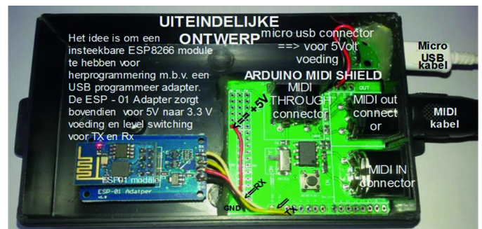
Afbeelding 7: ESP8266 OSC naar MIDI module
