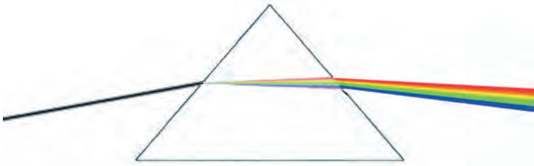
Afbeelding 2: breking door prisma
