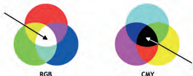
Afbeelding 5: additieve en subtractieve kleurmenging
