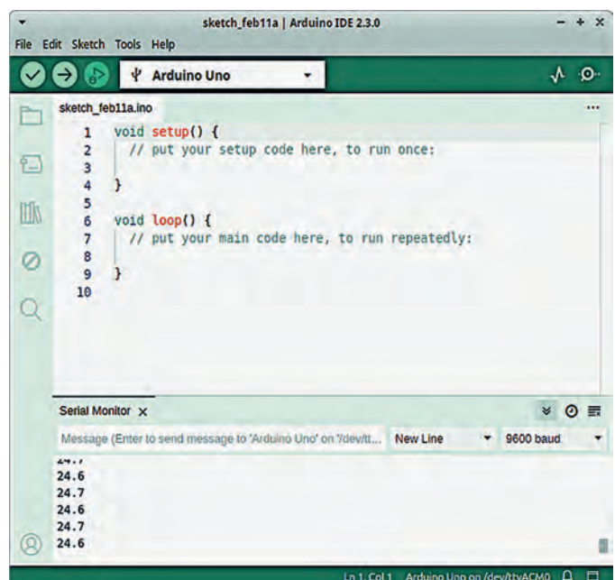
Arduino IDE seriële monitor met de waarden van een TMP36 temperatuursensor. Niet echt een sexy uiterlijk.
