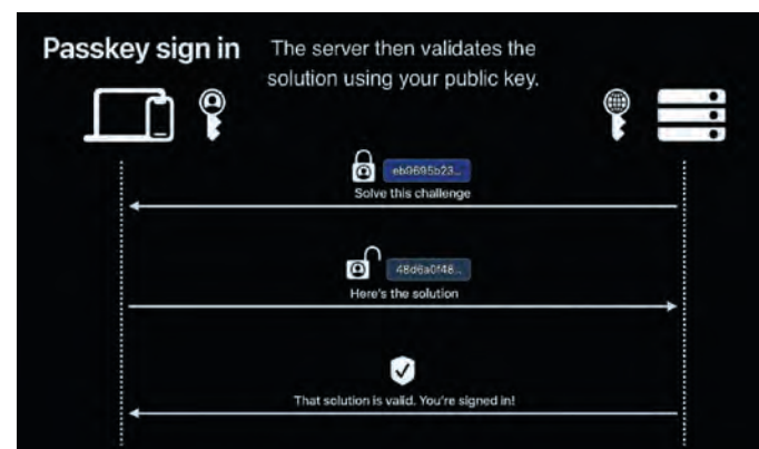
De website checkt met de openbare sleutel of de digitale handtekening met de bijbehorende privé sleutel is gezet
