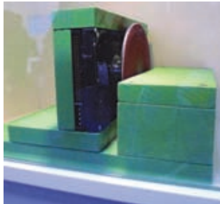
Schuurmachine op basis van een harddisk drive
